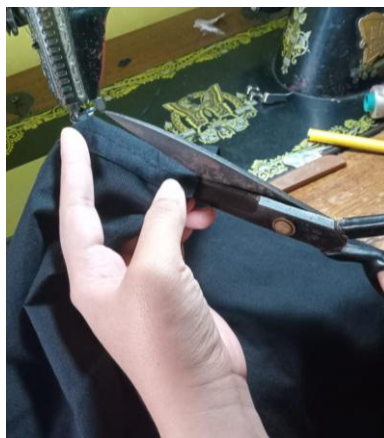
Gambar 2.2 Potong kain furing jas sesuai panjang dan lebar yang dibutuhkan
