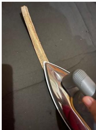
Gambar 2. 20 Batang eceng gondok di setrika
